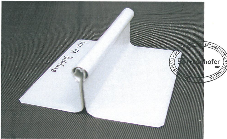
Bild 1: Ansicht des geprüften Stehfalzsystems aus Aluminiumprofilen mit Verbindungssteg (mit Wulstenfalzdichtung).
